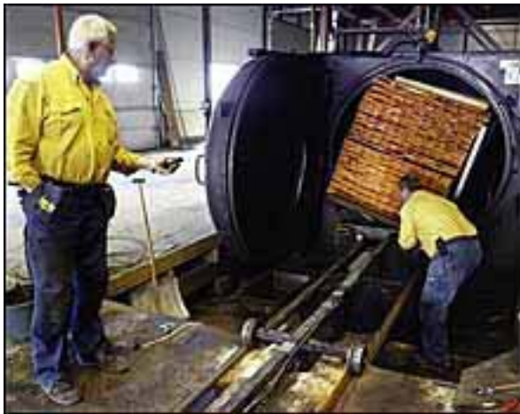
Ove Byh och Jan Thors på Lissma Såg & Bygg plockar ut det linolje-impregnerade virket ur autoklaven, i vilken oljan tryckts in i virket. Foto: Mats Andersson
